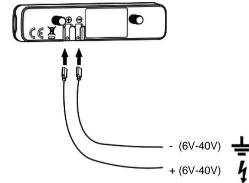
An der Rückseite des Rücklichtes befinden sich die Steckkontakte zum Anschluss an das elektrische System des E-Bikes. Die Steckkontakte bestehen aus Flachsteckerzungen. Bei dem Anschluss ist auf die richtige Polarität des Anschlusskabels zu achten.
