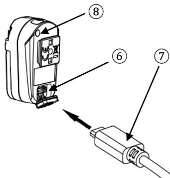
Zum Aufladen das USB-Kabel ⑦ mit einem USB-Standardnetzteil (5V, max. 1000mA) oder mit einem Computer verbinden. Öffnen Sie hierzu die Gummy-Abdeckung an der Rückseite der Leuchte und verbinden Sie die darunter befindliche Ladebuchse ⑥ mit dem kleinen Stecker des USB-Kabels ⑦. Anschließend verbinden Sie den großen Stecker des USB-Kabels ⑦ mit dem Ladestecker, wenn nicht schon geschehen. Danach stecken Sie den Stecker in eine Steckdose.
