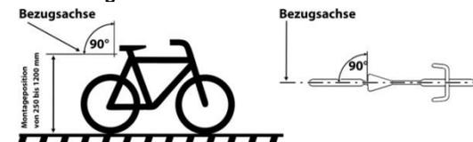
**Achtung:** Überprüfen Sie regelmäßig die richtige Einstellung und Anbauhöhe Ihres Rücklichtes. Das Rücklicht muss in einem Bereich von 250 bis 1200 mm über der Fahrbahn montiert werden. Es muss so angebaut und eingestellt werden, dass die Bezugsachse parallel zur Fahrzeuginnenmittelebene und parallel zur Fahrbahn liegt (siehe Abbildung).
