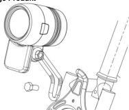
Scheinwerfer ① mittels Stahlhalterung ⑤ am Fahrrad befestigen und darauf achten, dass sich der Scheinwerfer ① nicht von allein wieder verstellen kann (Schraube fest genug anziehen!).
