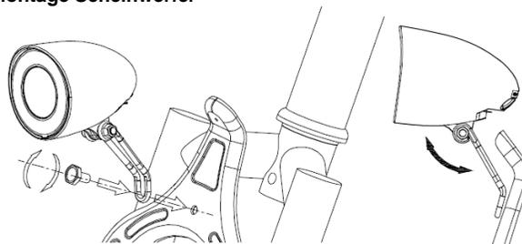
Scheinwerfer ① mittels Stahlhalterung am Fahrrad befestigen und darauf achten, dass sich der Scheinwerfer ① nicht von allein wieder verstellen kann (Schraube fest genug anziehen!).
