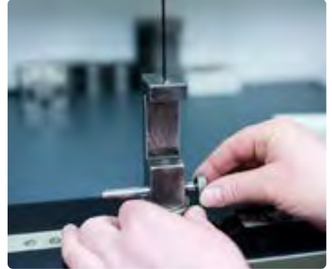
Zerreitest fr Fahrradspeichen
