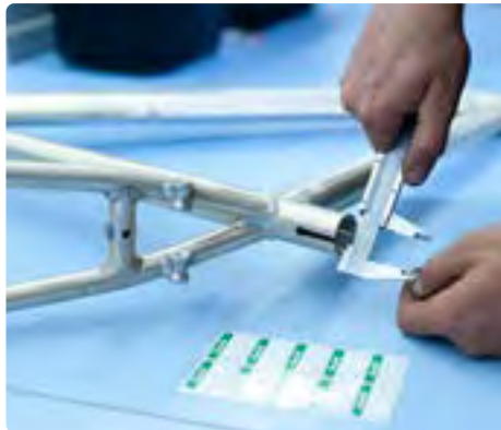
Routineberprfung eines Rahmens
