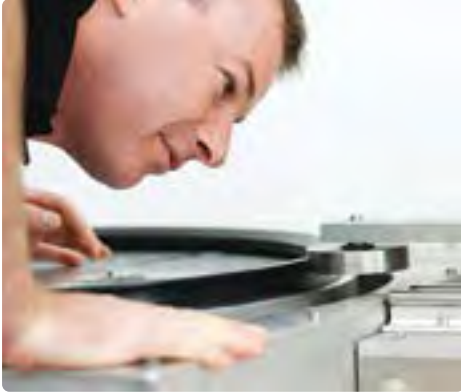
Überprüfen der Felgen auf Maßtoleranzen
