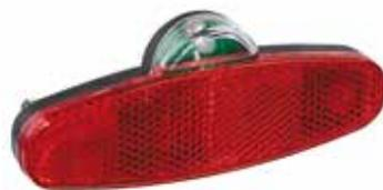
Dynamogestütztes LED-Gepäckträger-Rücklicht „Lipso Plus“ gemäß StVZO, mit Z-Reflektor, schnelle Kontaktierung durch Doppelkabel Push & Pull Stecker, Schraubenabstand 50 mm und 80 mm
