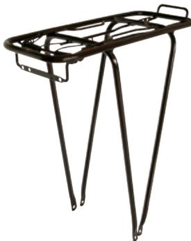
Trekkingrohrgepäckträger aus Präzisionsstahlrohr (10mm) in stabiler Ausführung und Federklappe, integrierter Rücklichtschutz für 26" und 28" Fahrräder
