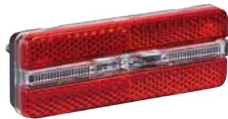
Dynamogestütztes LED-Gepäckträger-Rücklicht „Sunset Strip“ gemäß StVZO mit Z-Reflektor, speziellem Leuchtstreifen, Standlichtfunktion, schnelle Kontaktierung durch Push & Pull-Stecker für Doppelkabel, Schraubenabstand 80 mm
