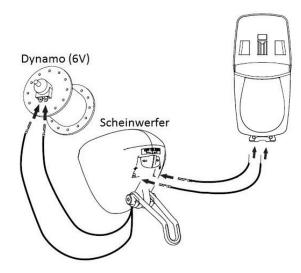
Das Rücklicht kann grundsätzlich sowohl an Naben- als auch an Seitenläufer-Dynamos angeschlossen werden die 6 V produzieren.
