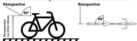
**Achtung:** Überprüfen Sie regelmäßig die richtige Einstellung und Anbauhöhe Ihres Rücklichtes. Das Rücklicht muss in einem Bereich von 250 bis 1200 mm über der Fahrbahn montiert werden. Es muss so angebaut und eingestellt werden, dass die Bezugsachse parallel zur Fahrzeuginnenfläche und parallel zur Fahrbahn liegt (siehe Abbildung).
