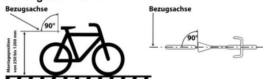
**Achtung:** Überprüfen Sie regelmäßig die richtige Einstellung und Anbauhöhe Ihres Rücklichtes. Das Rücklicht muss in einem Bereich von 250 bis 1200 mm über der Fahrbahn montiert werden. Es muss so angebaut und eingestellt werden, dass die Bezugsachse parallel zur Fahrzeuglängsmittellebene und parallel zur Fahrbahn liegt (siehe Abbildung).
