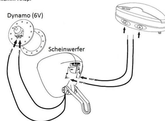
Das Rücklicht kann grundsätzlich sowohl an Naben- als auch an Seitenläufer-Dynamos angeschlossen werden die 6 V produzieren.
