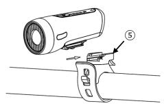
Positionieren und Befestigen Sie den Halter an der gewünschten Stelle am Lenker. Ziehen Sie die Gummilasche straff und haken Sie diese ein. Um den optimalen Winkel zur Fahrtrichtung einzustellen können Sie den Scheinwerfer in dem Halter werkzeuglos verdrehen. Schieben Sie den Scheinwerfer auf den Halter bis er hörbar einrastet. Zum Lösen drücken Sie die Scheinwerferarretierung und schieben den Scheinwerfer vom Halter aus nach vorne
